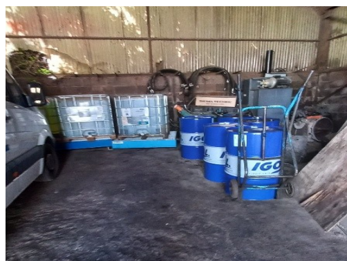
Photographie des produits chimiques hors rétentions dans le hangar de maintenance engins
