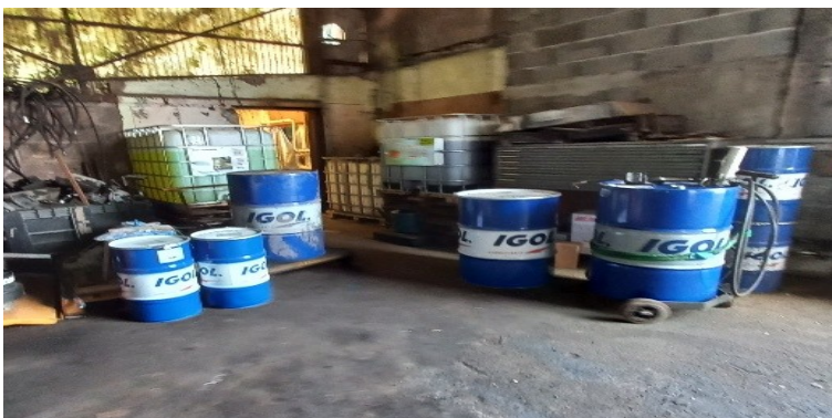
Photographie des produits chimiques hors rétentions dans le hangar de maintenance engins
